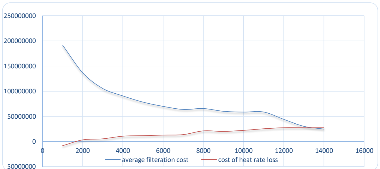
شکل ۱: نمودار هزینه متوسط فیلترها در هر ۱۰۰۰ ساعت کارکرد و نمودار هزینه ارزش حرارتی ازدست‌رفته در هر ۱۰۰۰ ساعت کارکرد اضافی
